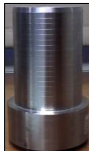
Gambar 7 Hasil Pembuatan Jig ID (Inside Diameter)
