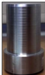
Gambar 7 Hasil Pembuatan Jig ID (Inside Diameter)
