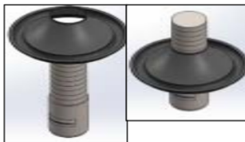
Gambar 10 Proses Pengukuran dengan Menggunakan Jig ID (Inside Diameter)
