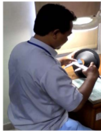
Gambar 9 Proses Pengukuran dengan Menggunakan Jangka Sorong ( Caliper Digital )200mm
