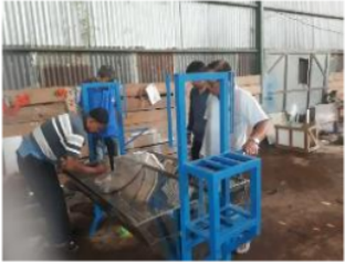
Gambar 1. Perakitan Komponen Mesin Pelorod
