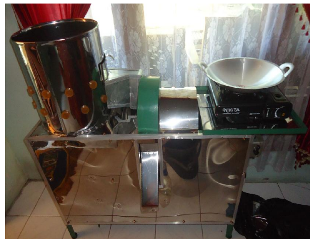
Gambar 1. Mesin Pengelupas, Pengiris dan Penggorengan Bawang
