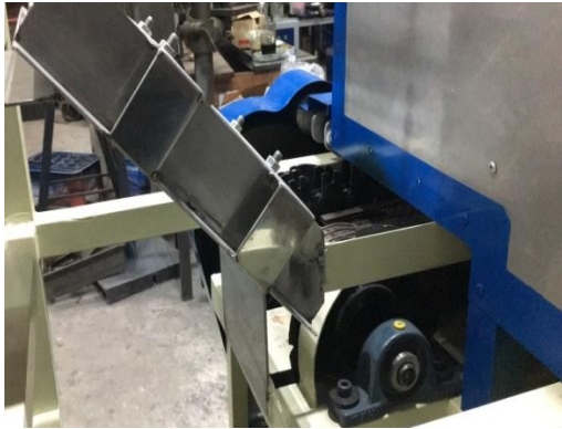
Gambar 3.24 Penempatan Conveyor Dengan Tungku.
