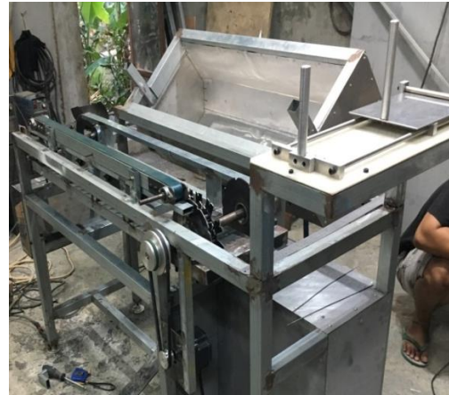
Gambar 3.26 Pengujian Mesin. TAMPAK MESIN PEMBUAT DAN PEMBAKAR SATE KAPASITAS 25KG/JAM.
